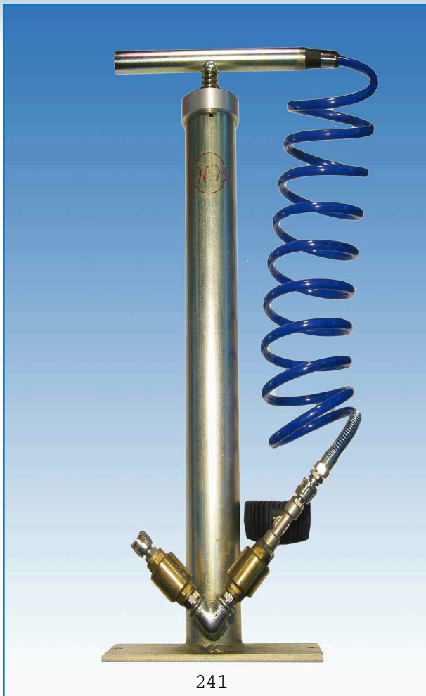
ART. 241 Pompa per palloni otturatori, costruita interamente in acciaio zincato. Dotata di manometro per controllo pressione con cuffia di protezione, due valvole unidirezionali per gonfiaggio e sgonfiaggio palloni in gomma flessibile con attacco rapido.
