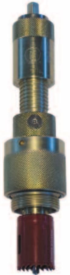
La macchina foratubi (ART.45) è costruita in acciaio con doppia zincatura. Permette di realizzare fori, in qualunque posizione, su reti a gas a bassa pressione attraverso rubinetti in bronzo per colonne montanti da 1" e 1,1/2" con risultati ottimali e in condizioni di totale sicurezza.
