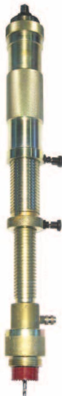
La macchina foratubi (ART.26) è costruita in acciaio con doppia zincatura e permette di realizzare fori, in qualunque posizione, su reti a gas e acqua da 1" a 6" fino a 16 BAR.
